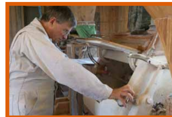
KONTROLL I VALSSTOLEN. Bengt Nybergh, mjölnare på Limabacka kvarn, kontrollerar godsets färg i valsstolen och avgör om mjölet är färdigt eller ska malas vidare.
